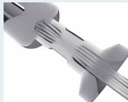
Обжимное соединение в продольном разрезе
