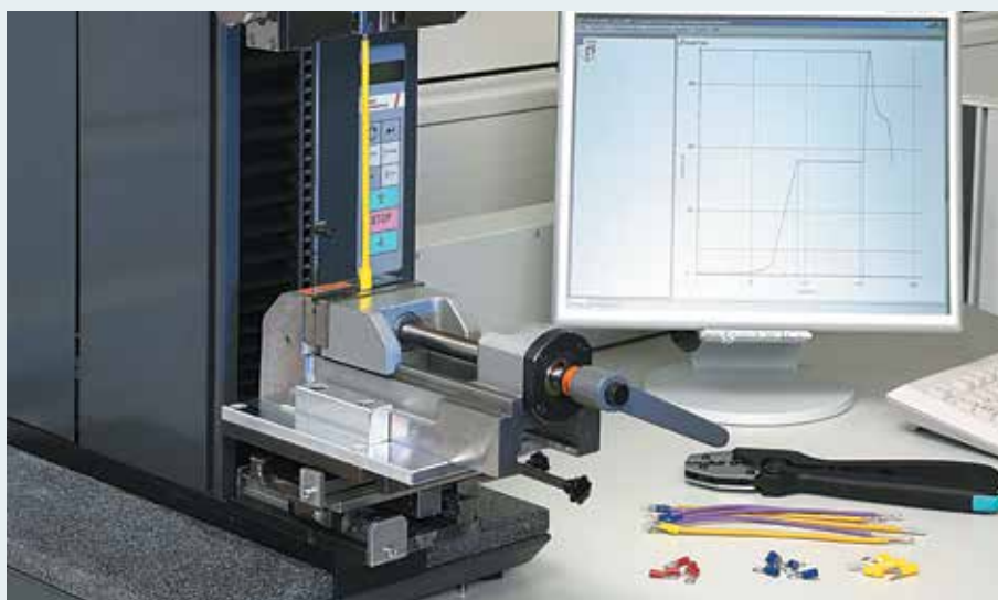
Испытания проводника на выдергивание
