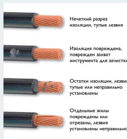
Зачистка не соответствует DIN МЭК 60352-2
